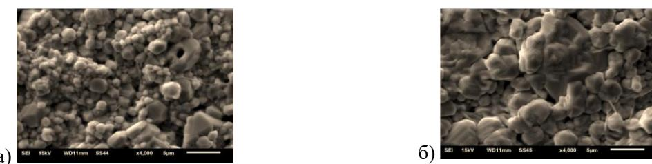
Рисунок 1. РЭМ изображения структуры зерен керамики  $\text{Ba}_{0,5}\text{Sr}_{0,5}\text{TiO}_3$  (а) и  $\text{Ba}_{0,9}\text{Sr}_{0,1}\text{TiO}_3$  (б). Масштабная метка 5 мкм.
