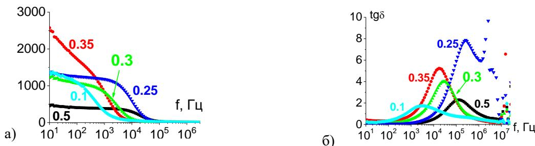
Рисунок 2. Частотные зависимости диэлектрической проницаемости (а) и тангенса угла диэлектрических потерь керамики  $\text{Ba}_{1-x}\text{Sr}_x\text{TiO}_3$
